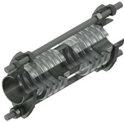
Die Wirkungsweise der Lateralkompensatoren beruht wie die der Angularkompensatoren auf Winkelbewegungen der Stahlbälge. Sie eignen sich auch für beengte Einbauverhältnisse. Die Dehnungsaufnahme ist abhängig von der Baulänge bzw. dem Balgmittenabstand: Je grösser der Balgmittenabstand, desto grösser ist die laterale Dehnungsaufnahme.
